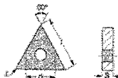
Рисунок 3.36 – Сменная твердосплавная пластина ISCAR TNMG
