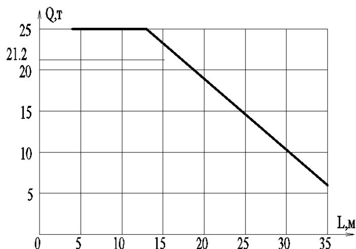
Рисунок 3.5.1. График грузоподъемности КБ-674.исп.05
