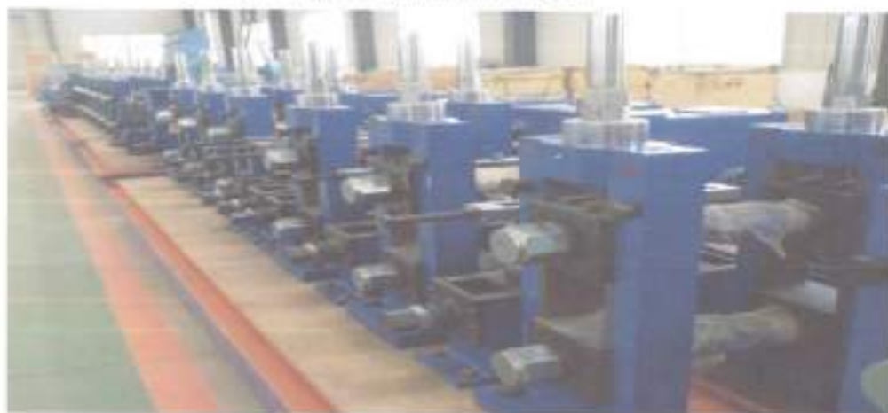
Рисунок 3.2 – Высокочастотная полупроводниковая сварочная линия для производства профильных труб
