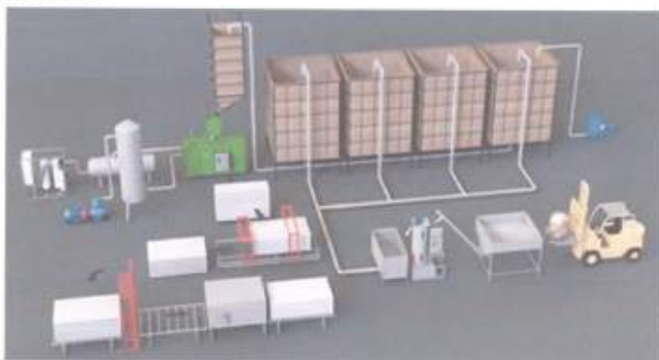
Рисунок 3.1 – Комплект оборудования для производства пенополистирола Поставщиком данного оборудования выступает Компания "Stan-M polichemical", г.Пермь.
