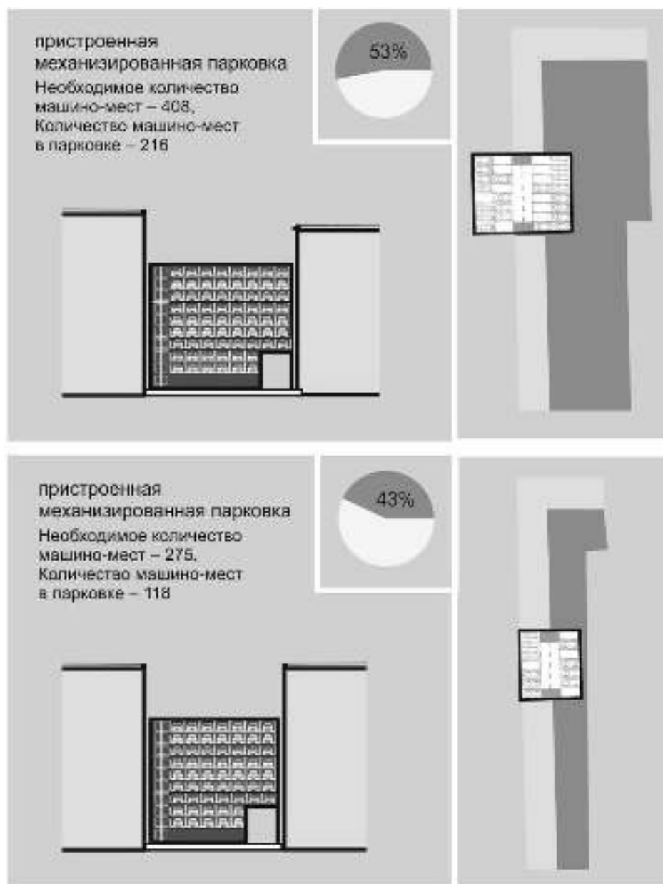
Рисунок 8. Приемы встраивания механизированных пристроенных парковок в структуру жилых образований
