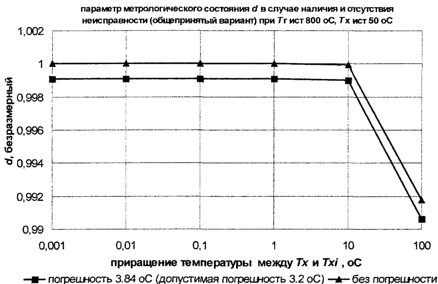
Рис. 2. Зависимость метрологического параметра d от приращения температуры холодного сая
