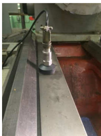
Рисунок 2.2 – Крепление однокомпонентного датчика СТС АС102-1А
