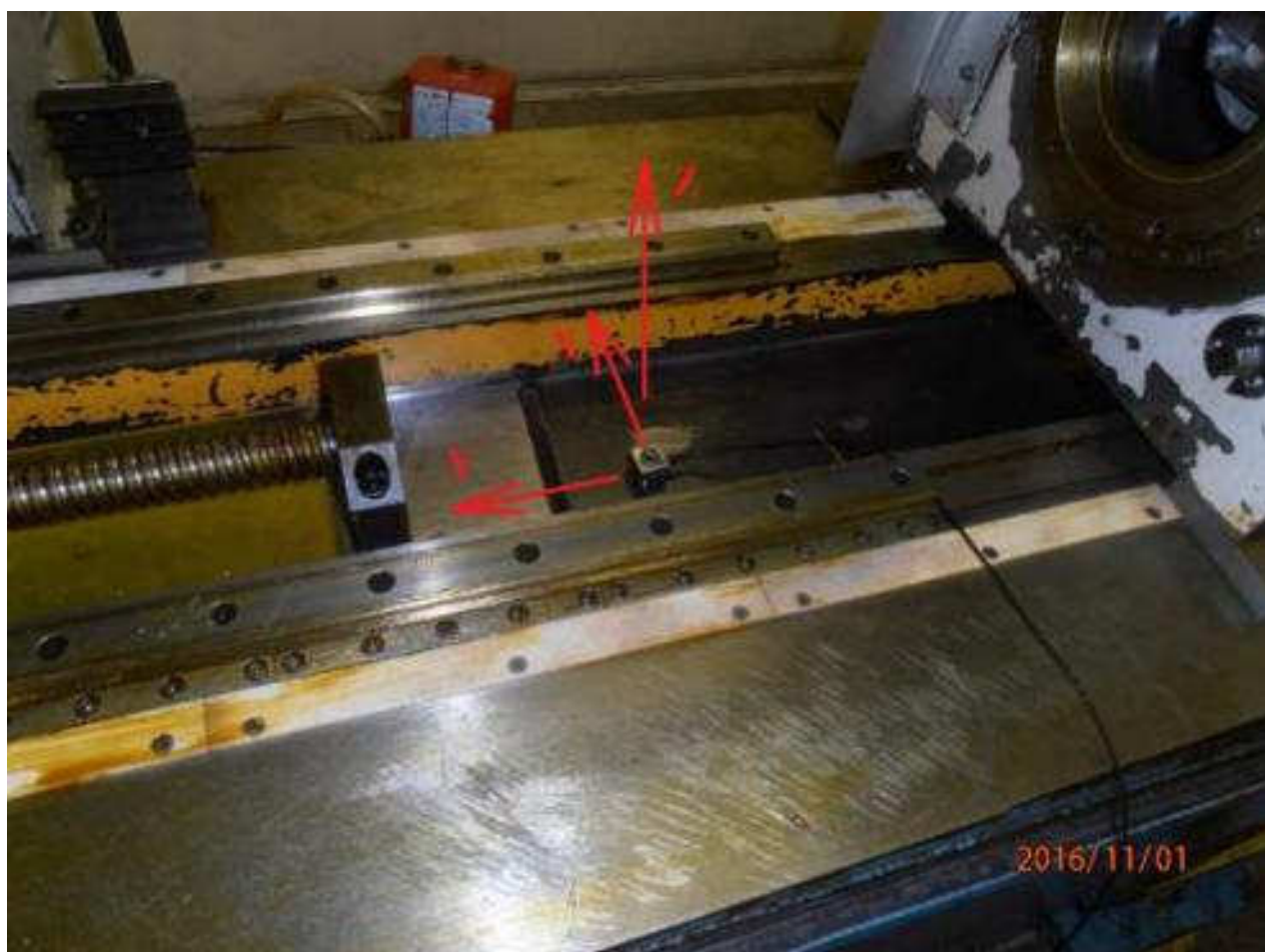
Рисунок 2.14 – Крепление датчика на станине токарного станка
