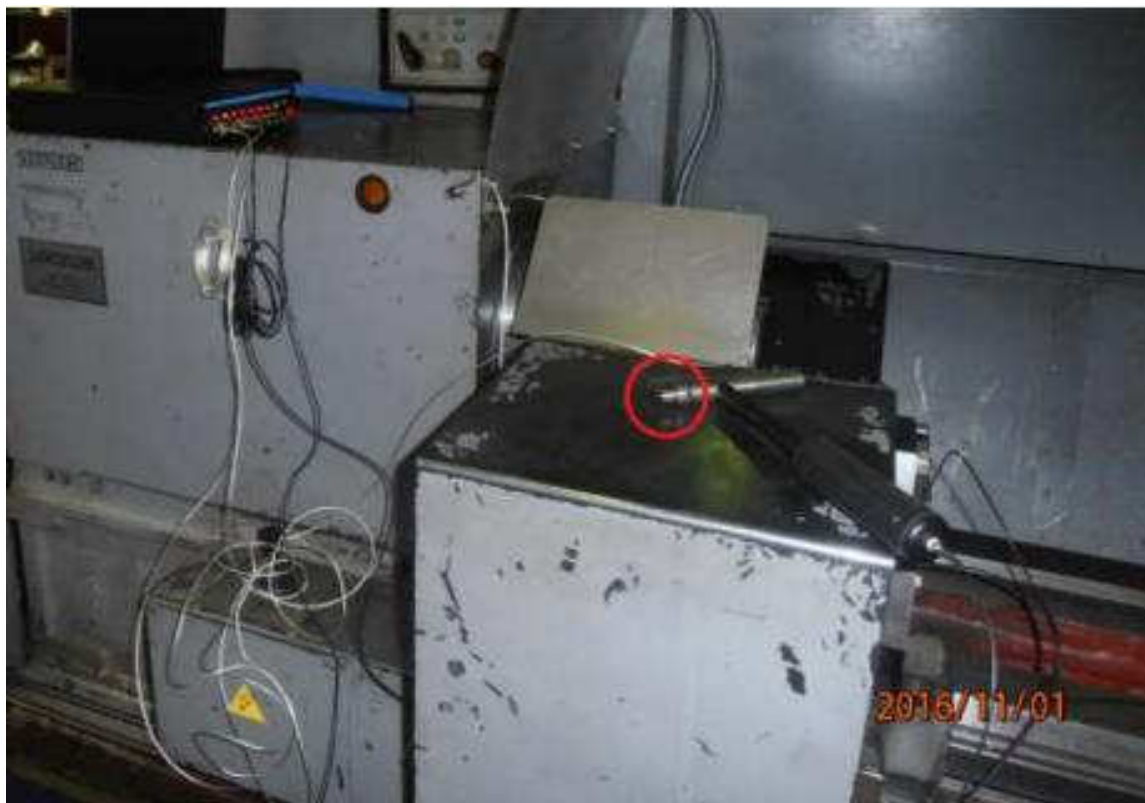
Рисунок 2.13 –Ударный молоток с датчиком силы
