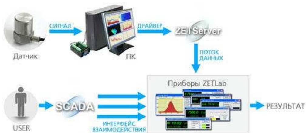
Рисунок 4.3 – Схема работы SCADA ZETView
