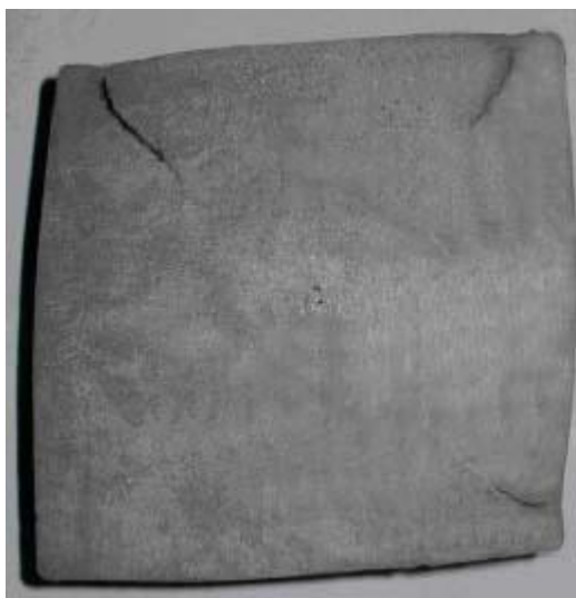
Рисунок 4 - Поперечное сечение сортовой заготовки с повышенной ромбичностью и внутренними трещинами
