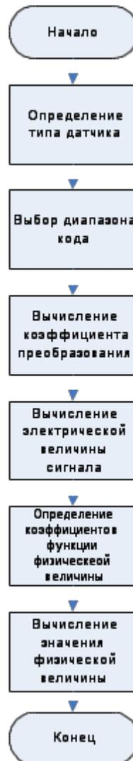
Рисунок 3.19 – Алгоритм функции FC11
