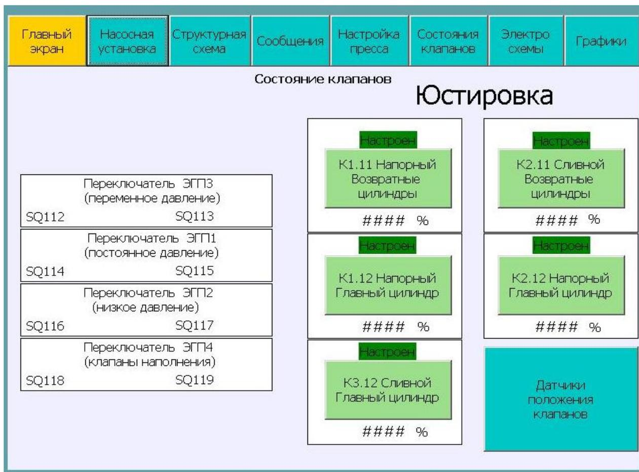
Рисунок 3.29 – Экран «Состояние клапанов»
