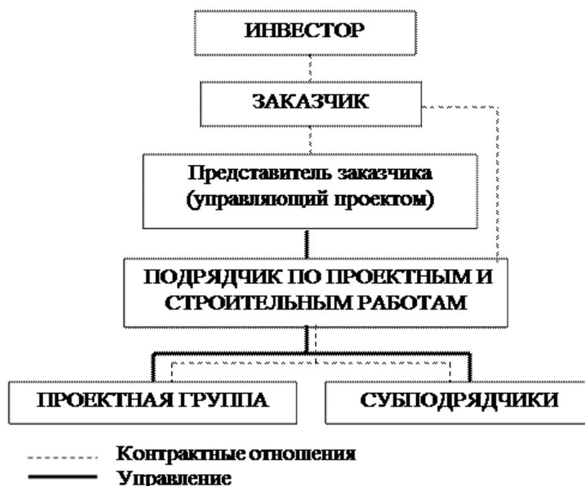
Рисунок 1.5– Схема «проектирование и строительство» взаимодействия между участниками инвестиционно-строительного комплекса
