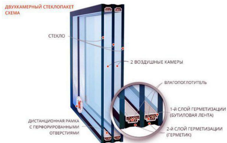
Рисунок 4 – Схема двухкамерного стеклопакета
