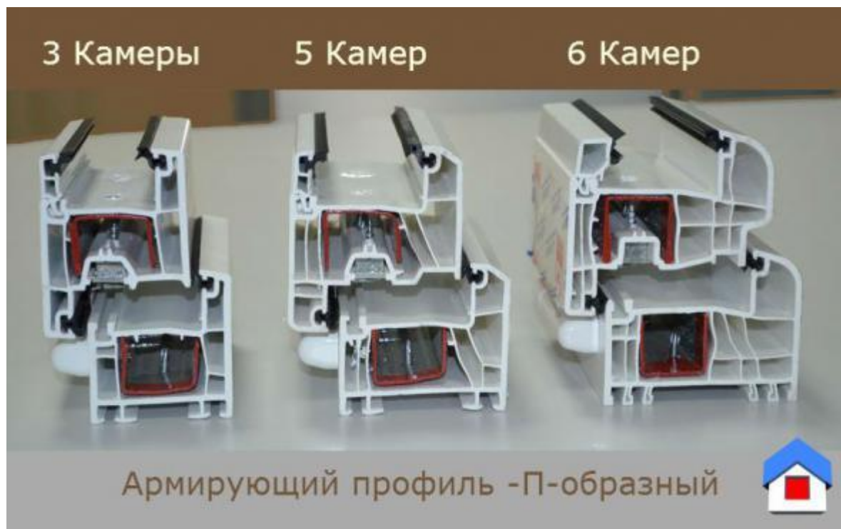
Рисунок 5 – Разновидность профилей по камерам
