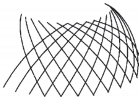
Рис. 7 Образование сетчатой поверхности вращением наклонных образующих
