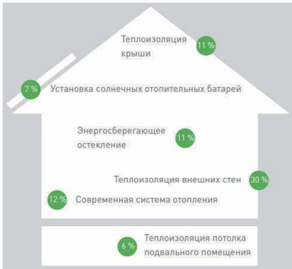
Рисунок 1.2 - Потенциал энергосбережения для типичного здания
