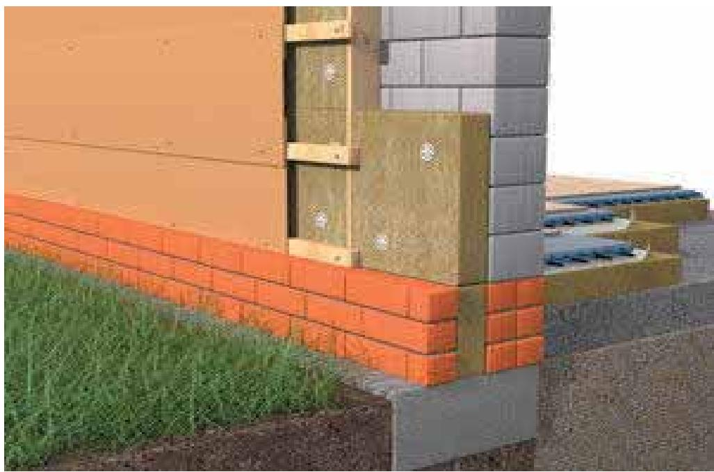
Рисунок 1.10 - Конструкция стены дома Natural Balance
