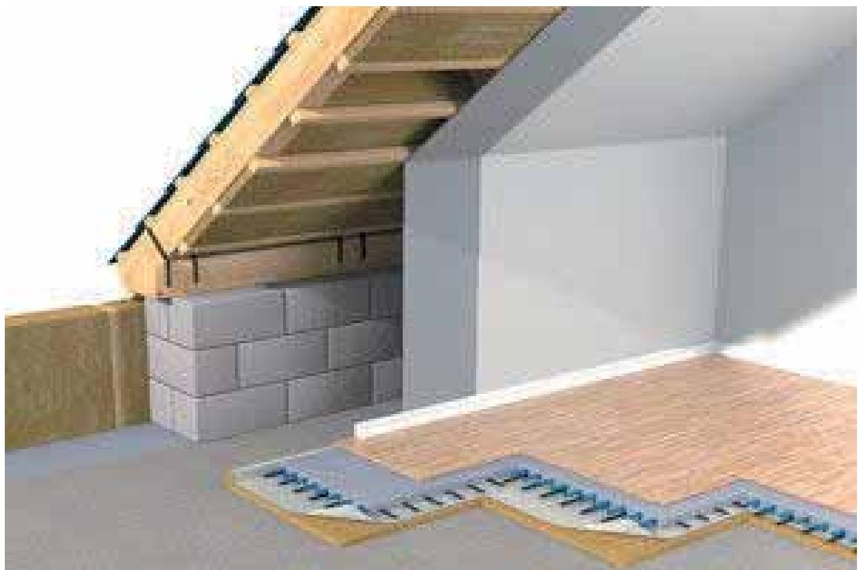
Рисунок 1.11 - Конструкция кровли дома Natural Balance
