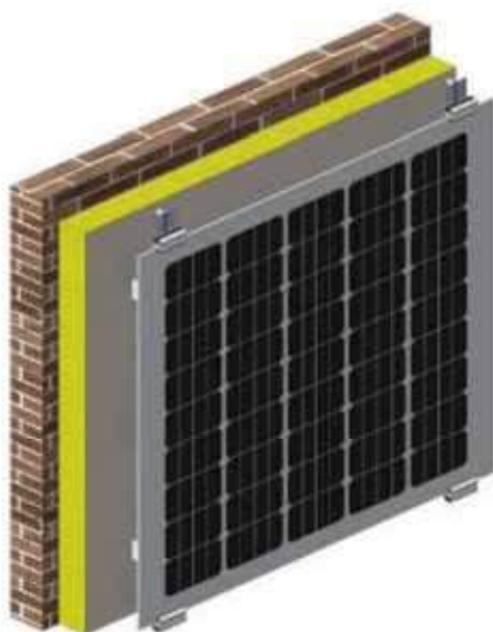
Рисунок 19. Схема монтажа солнечной панели на вентилируемом фасаде.
