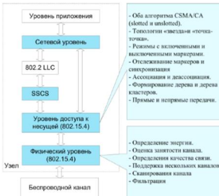
Рисунок 7 – Структура компонентов модели LR-WPAN NS-2
