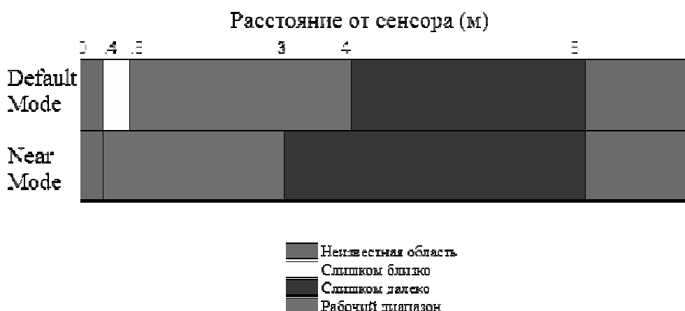
Рисунок 13 - Режимы работы камеры глубины сенсора Kinect
