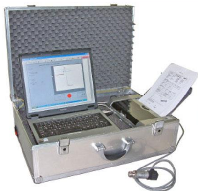
Рисунок Г.3 – Система регистрации, документирования и архивирования данных испытаний арматуры «EFCO-VALVE-DOC»
