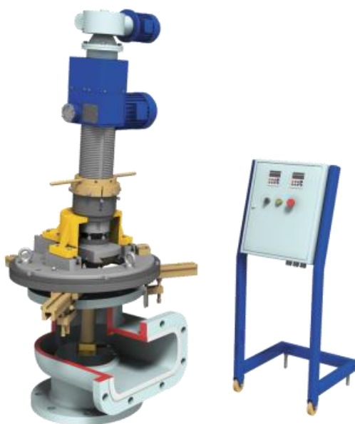
Рисунок Д.7 – Станок специализированный переносной «ГАКС–Л–2–400/600М» для комплексной механической обработки (шлифование и притирка)
