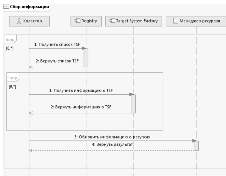
Рис. 4. Диаграмма последовательности сбора информации в системе CAEBeans Broker
