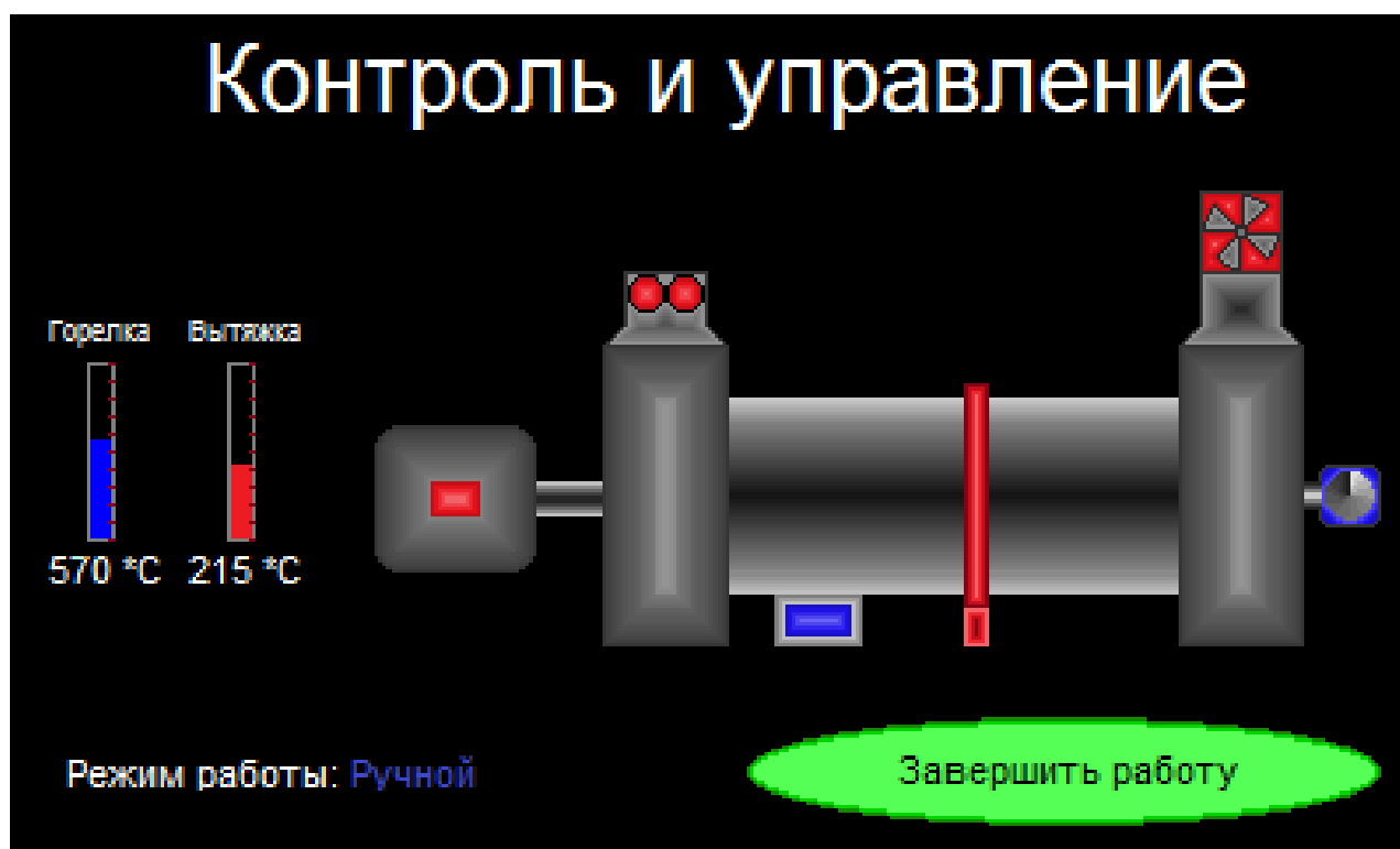
Рисунок 3.3 – Панель контроля и управления барабанной печью. Работа в ручном режиме, температура внутри горелки ниже допустимой нормы, температура у вытяжки выше допустимой нормы; для демонстрации отключена работа вибратора и шнека (синего цвета)
