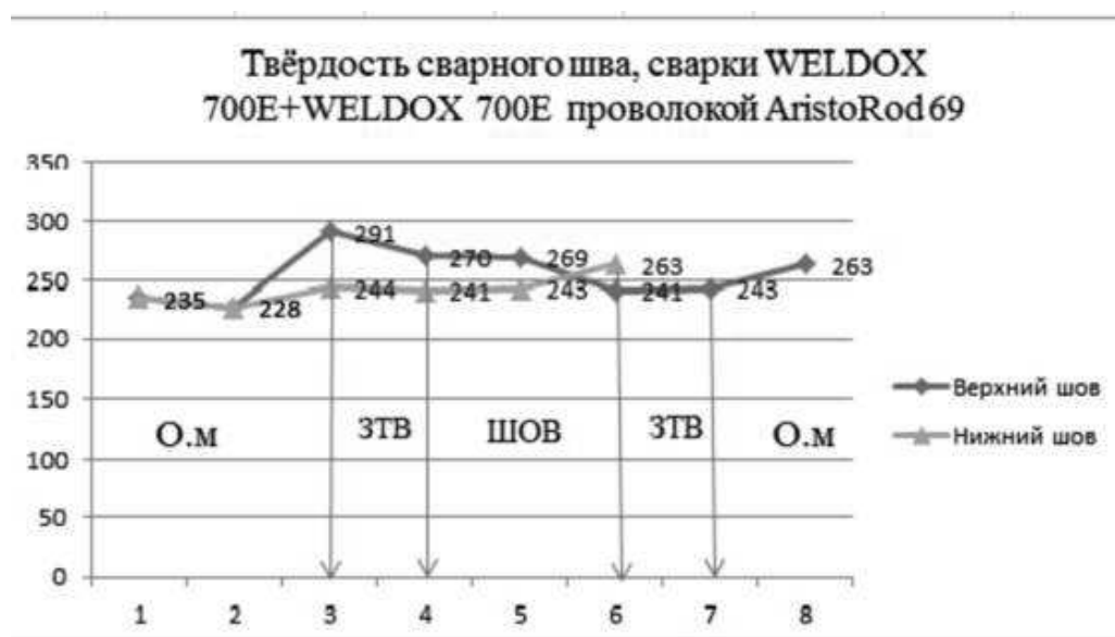
Рисунок 3.16 – Замер твердости на темплете WELDOX 700E + WELDOX 700E проволокой AristoRod 69
