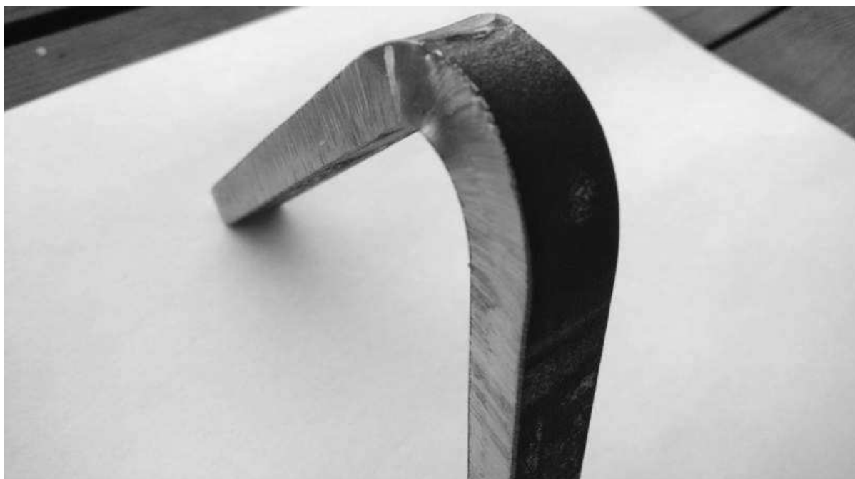
Рисунок 3.3 – Трещина в изгибе
