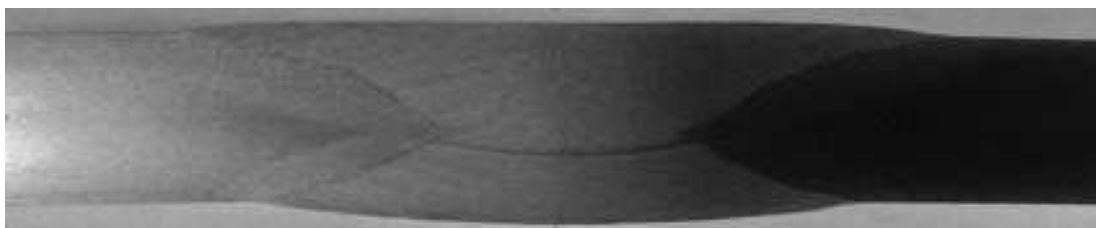
Рисунок 3.15 – Темплеты, вырезаны и протравленные раствором азотной кислоты.
