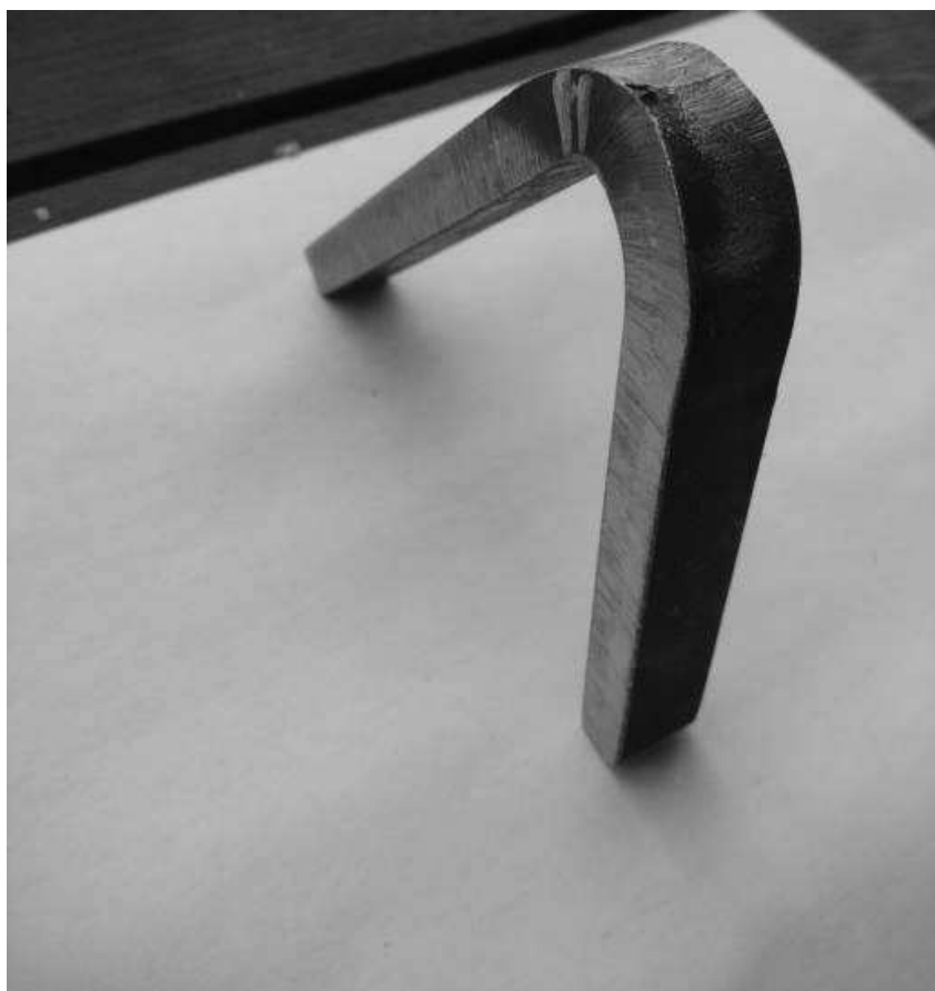
Рисунок 3.5 – Трещина в изгибе
