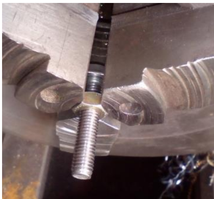
Рисунок 2.11 – Болт с гайкой закреплены в шпинделе станка 1К62
