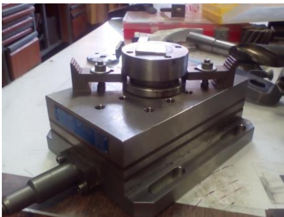
Рисунок 2.21– Фиксирующее устройство, закрепленное с помощью изготовленных шпилек на динамометре
