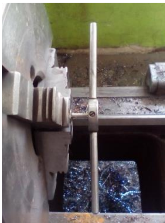
Рисунок 2.12 – Болт, обработанный по длине L до диаметра d = 5,8\text{мм} с фаской На резьбонарезной операции плашкой нарезана резьба M6 \times 1 (рисунок 2.13).
