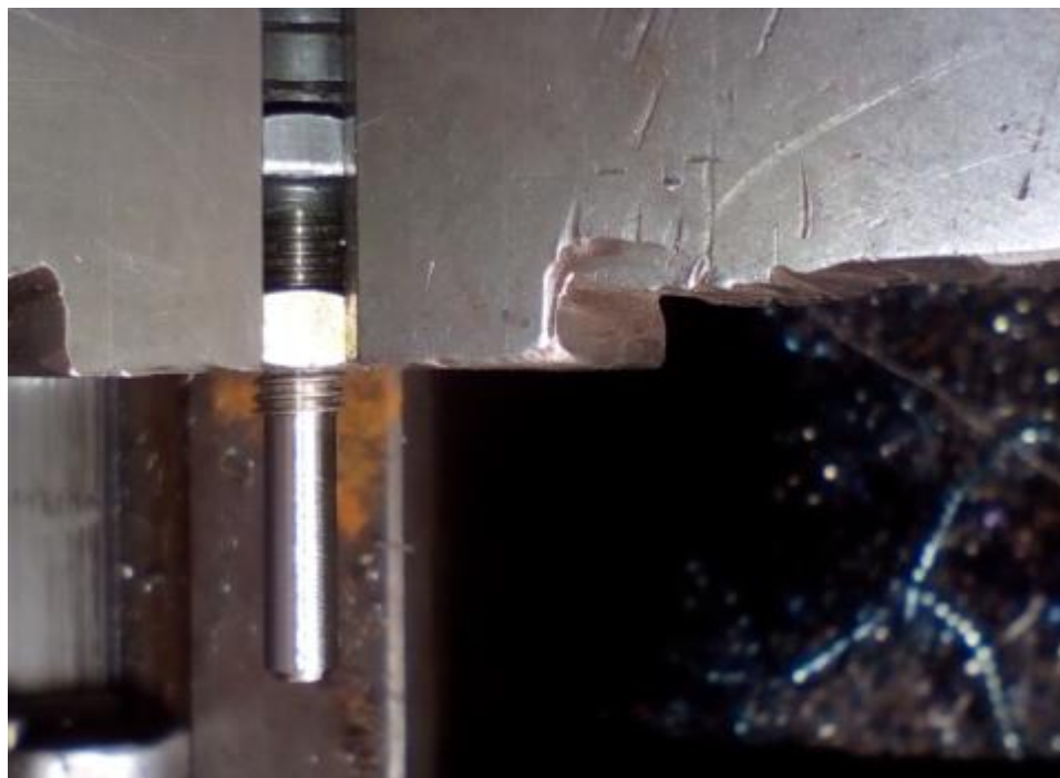
Рисунок 2.12 – Болт, обработанный по длине L до диаметра d = 5,8\text{мм} с фаской На резьбонарезной операции плашкой нарезана резьба M6 \times 1 (рисунок 2.13).
