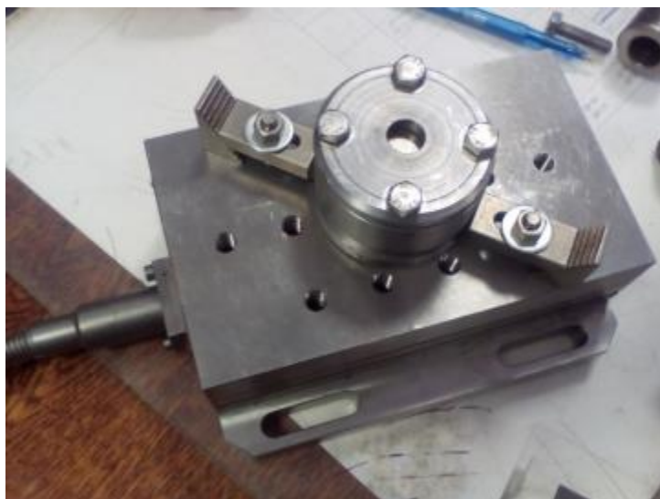
Рисунок 2.22 – Собранная установка для исследования термического сверления
