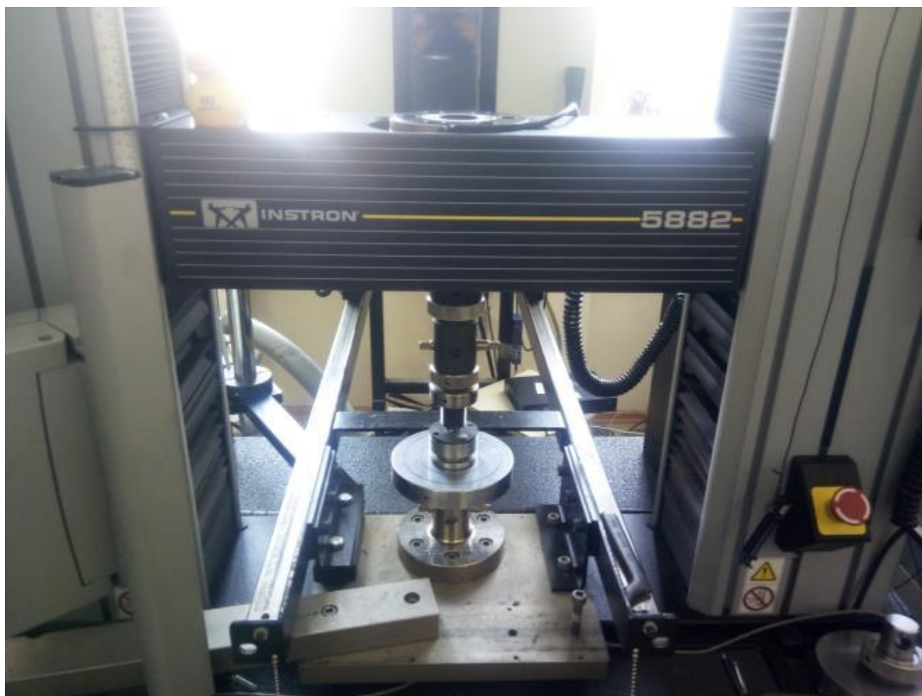
Рисунок 3.4–Электромеханическая универсальная испытательная машина Instron 5882
