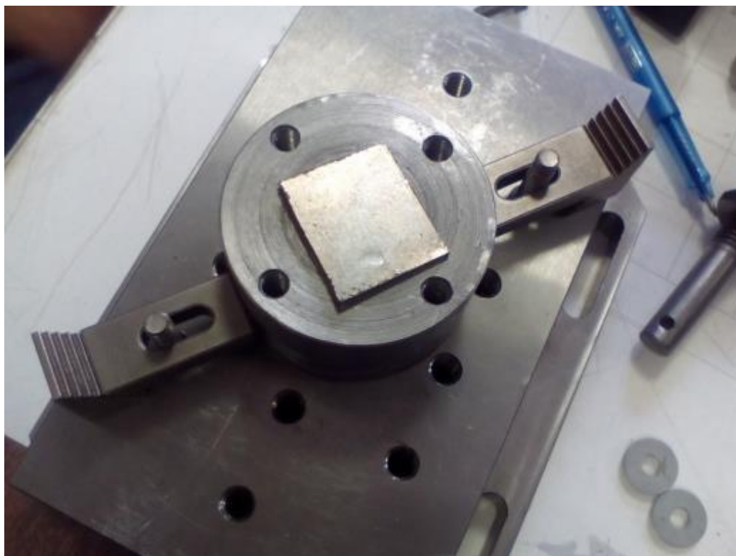
Рисунок 2.20 – Заготовка и фиксирующее устройство до закрепления на динамометре
