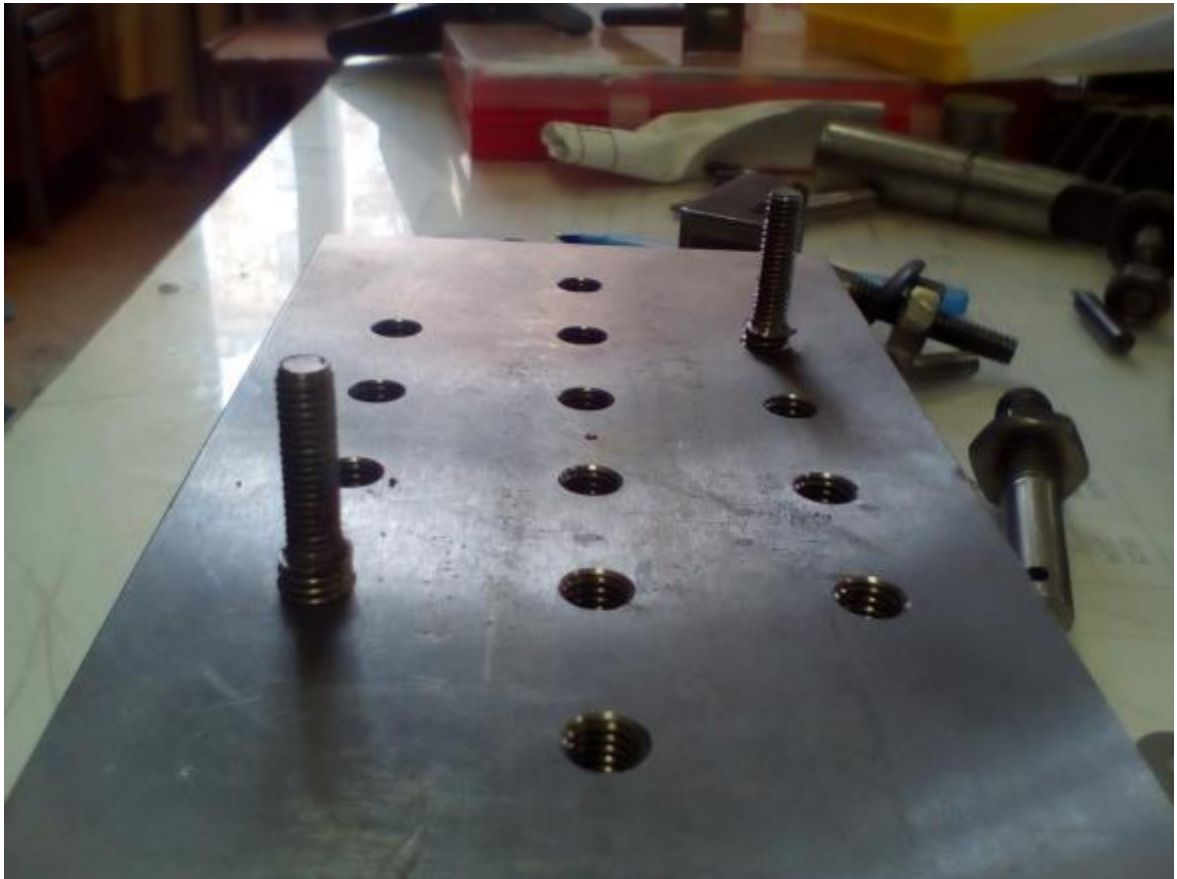
Рисунок 2.18 – Шпильки ввинчены в резьбовые отверстия динамометра
