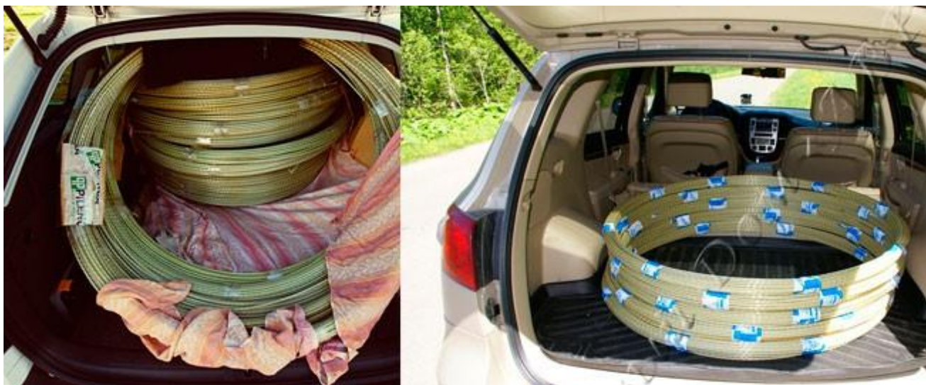
Рисунок 3.3 – Стеклопластиковая арматура в процессе перевозки
