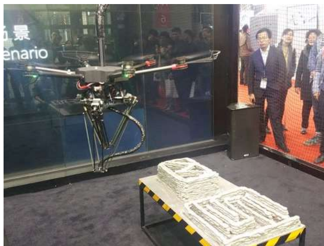
Рис.25 Прототип летающего 3D-принтера Dedibot
