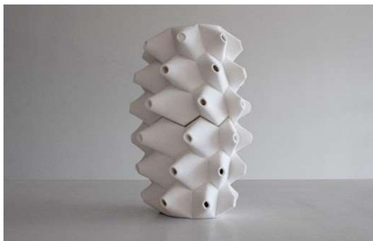
Рис.11 Стена из распечатанных соляных плиток
