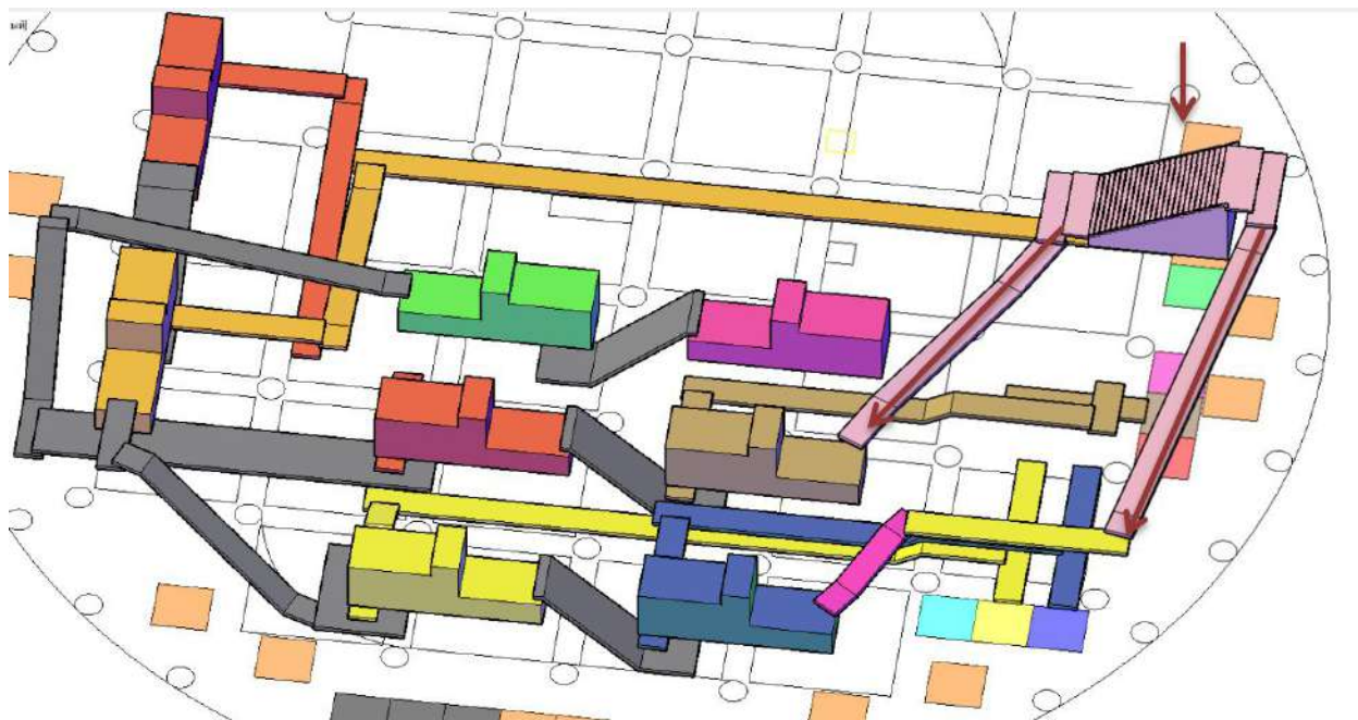
Рис. 3.9. Технологическая линия сортировки крупной фракции на -2 этаже
