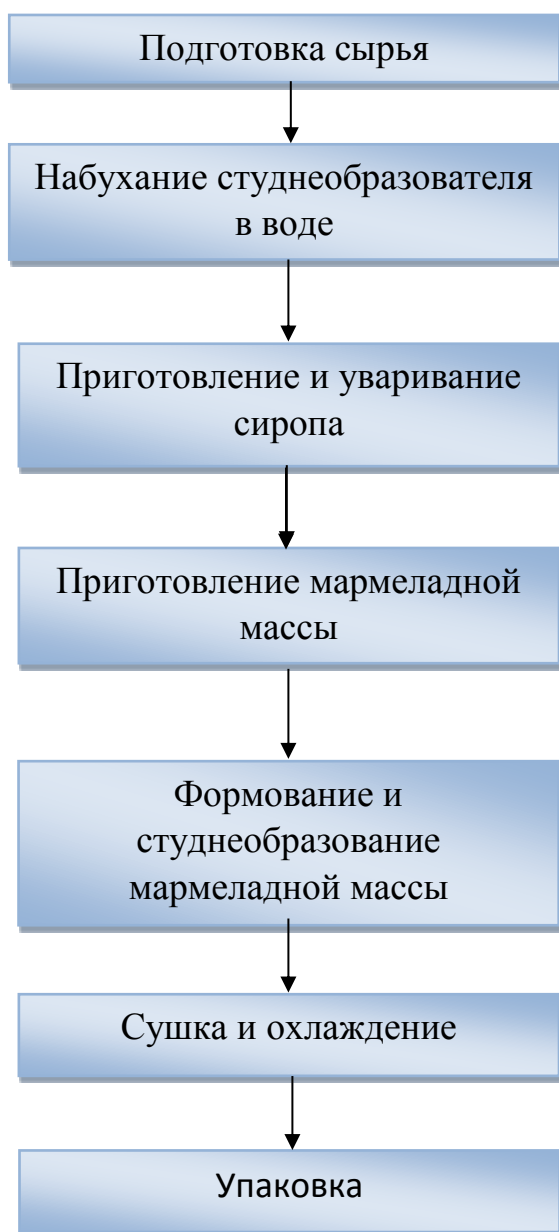
Рисунок 7 – Технологическая схема производства желейно-фруктового мармелада
