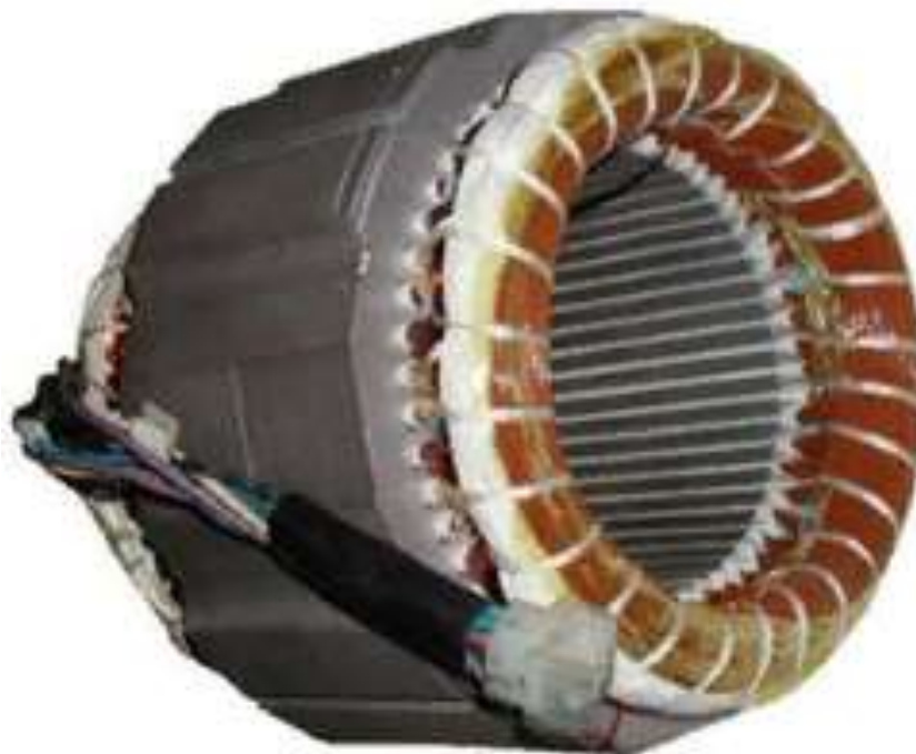
Рисунок 2.4 – Статор электродвигателя с распределенной обмоткой
