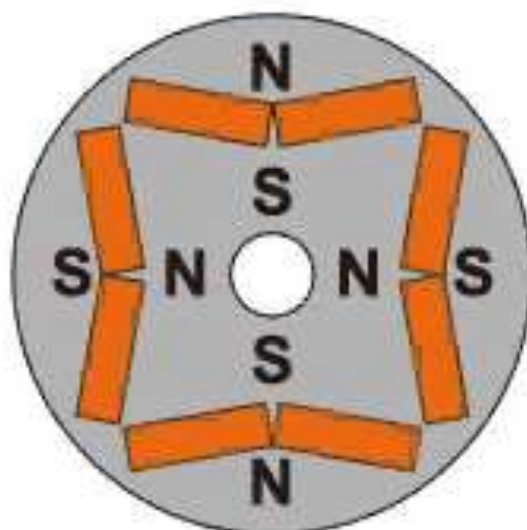
Рисунок 2.3 – Ротор синхронного двигателя со встроенными магнитами
