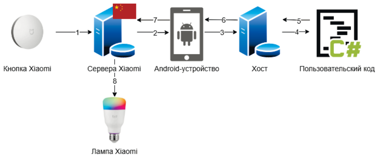
Рисунок 11 – Принцип работы расширяемой системы с разработанной модификацией приложения MI Home
