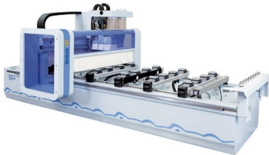
Рисунок 4 - Универсальный обрабатывающий центр с ЧПУ Venture
