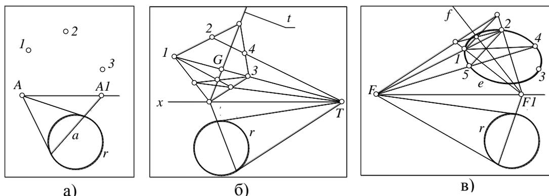
Рис. 1. Построение коники  $e$ , проходящей через точки 1, 2, 3 и через мнимые точки пересечения окружности  $r$  с прямой  $x$ : а – исходные данные; б, в – построение дополнительных точек 4, 5
