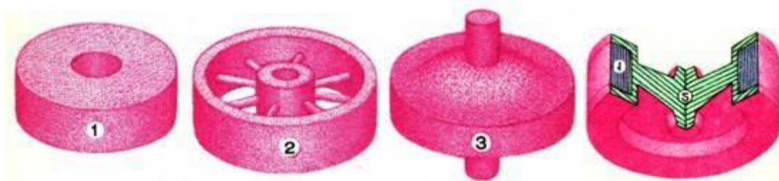
Рисунок 2.1 – Основные типы маховиков: 1 – диск с отверстием; 2 – обод со спицами; 3 – кольцевой маховик; 4 – супермаховик
