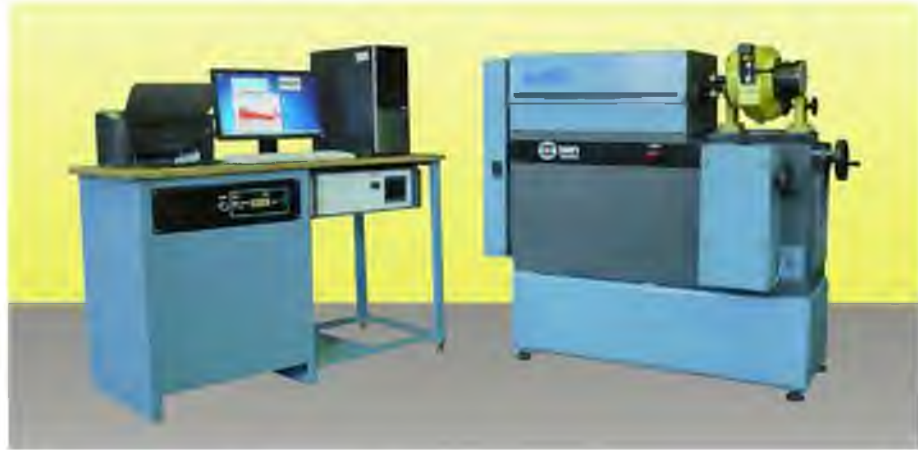
Рисунок 13 – Машина трения ИИ5018
