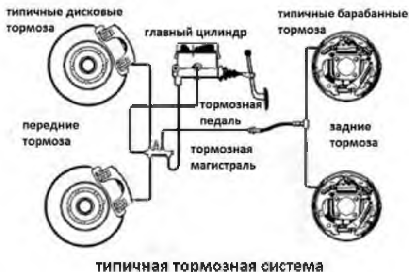
Рисунок 2 – Общая схема тормозной системы
