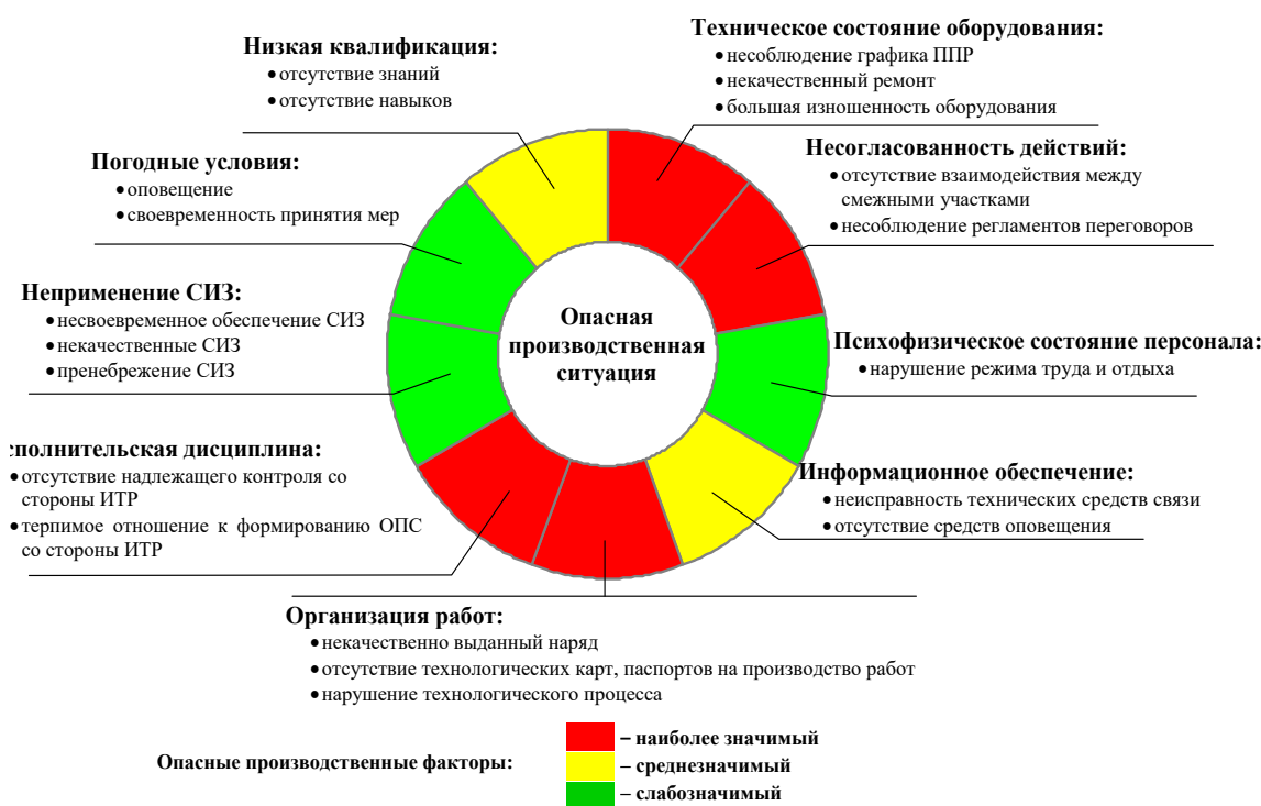
Рисунок 3 – Структурная схема опасной производственной ситуации
