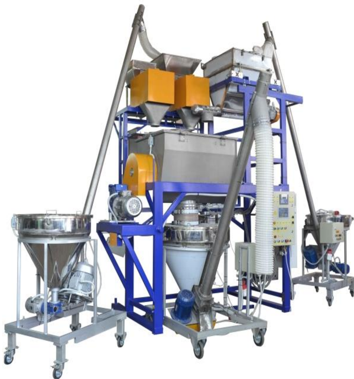
Рисунок 13 – Линия взвешивания, смешивания и дозирования сыпучих материалов
