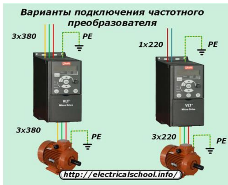
Рисунок 34 – Варианты подключения частотного преобразователя
