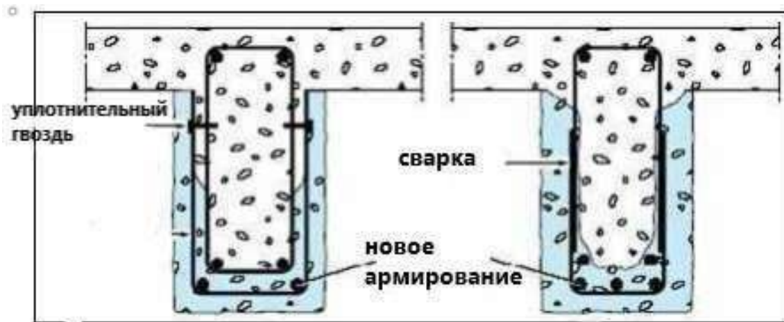
Рис.8.10. Добавление дополнительного подкрепления
