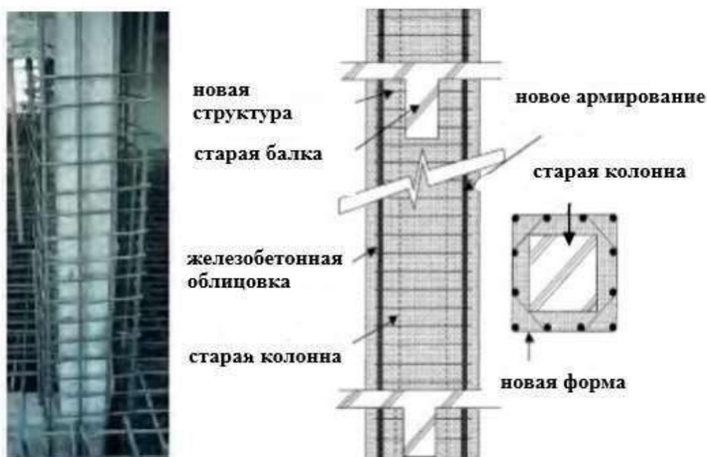
Рис.8.9. Железобетонная облицовка
