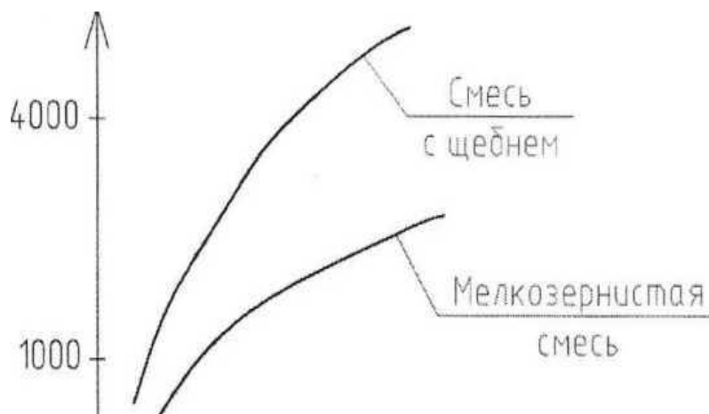
Рисунок 6. Зависимость вязкости от жесткости при разных компонентах смеси.
