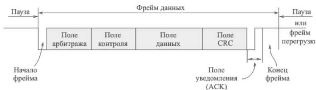
Рисунок 2.21. Структура фрейма данных CAN-интерфейса
