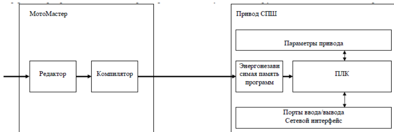
Рисунок 2.26. Взаимодействие программы «МотоМастер» и встроенного ПЛК сервопривода
