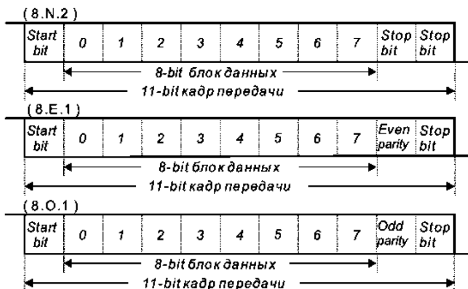
Рисунок 3.7. Кадр передачи в Modbus RTU
