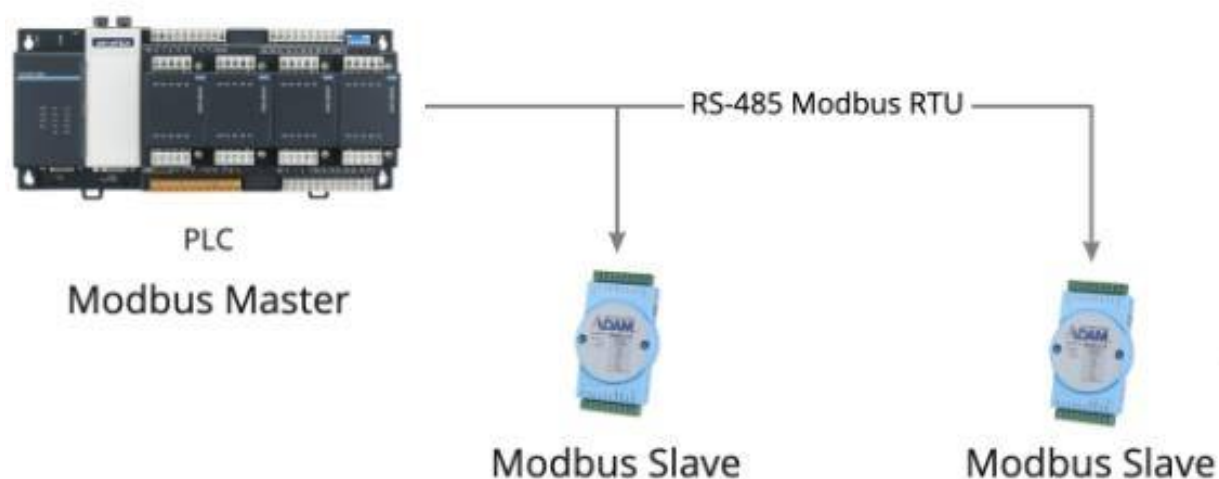
Рисунок 3.6. Схема архитектуры ведущий-ведомый
