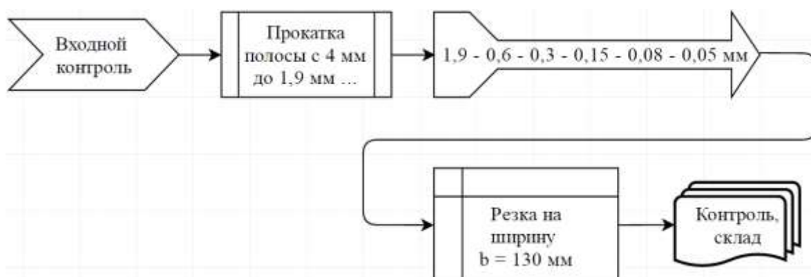
Рисунок 21 – Технологическая схема получения биметаллической фольги в условиях ЮУрГУ.
