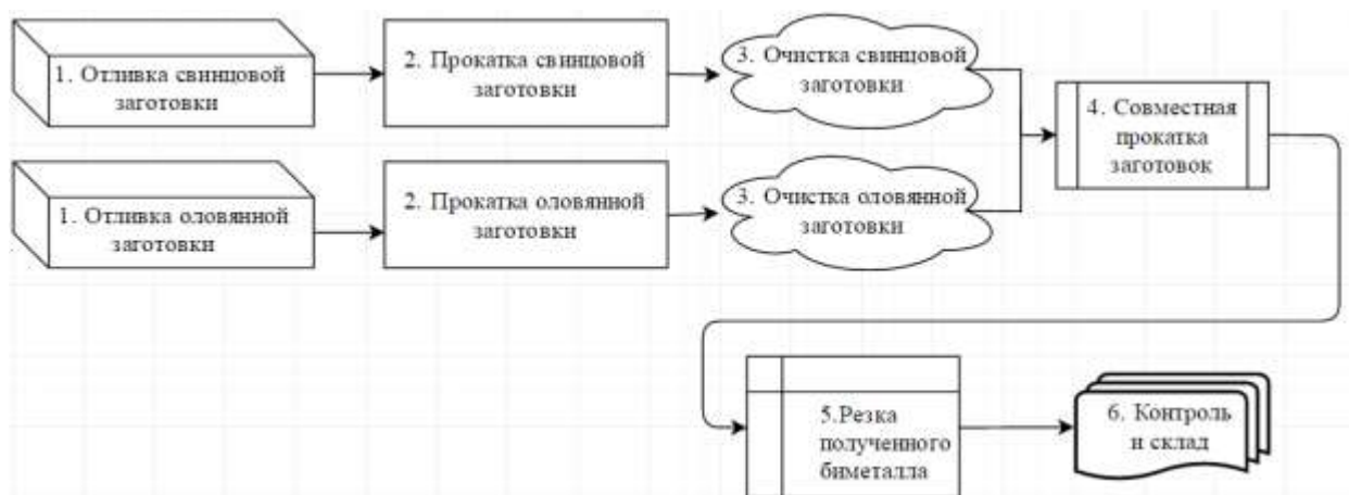
Рисунок 14 – Схема технологического процесса производства свинцовой фольги, плакированной оловом, на ООО НПО «РосАнтикор».
