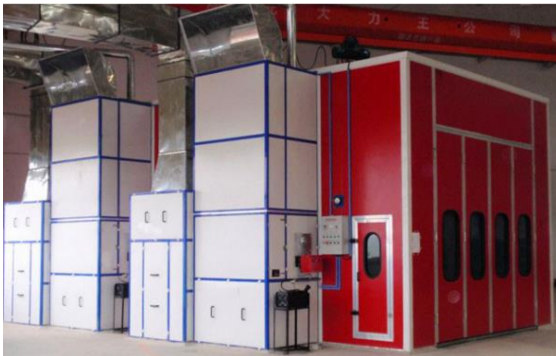
Рисунок 3.3 – Общее фото готовой покрасочной камеры
