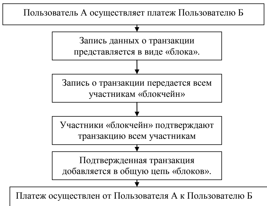
Рисунок 25 – Общая схема международных платежей с использованием технологий блокчейн и распределенных реестров
