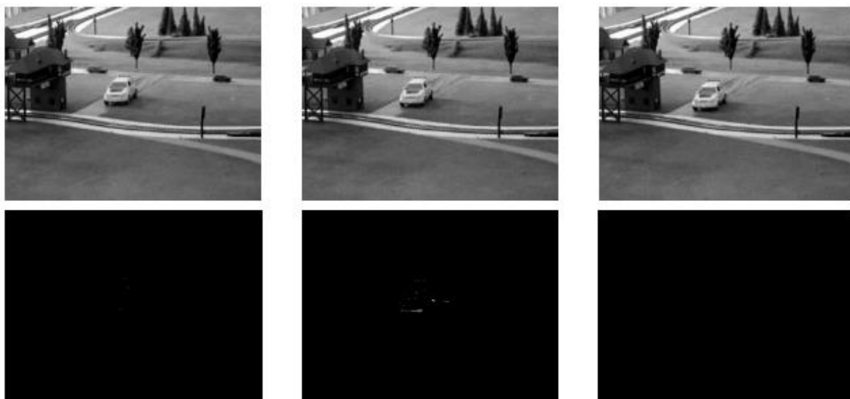
Рисунок 1.2 – Работа алгоритма вычитания фона на видеопоследовательности с автомобилем
