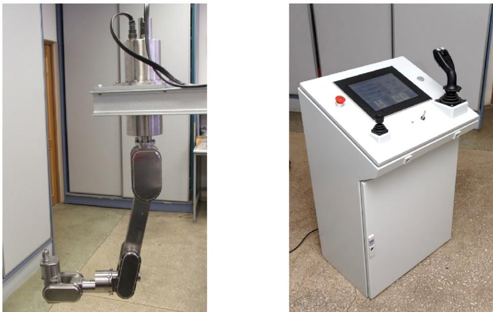
**Рис. 3. Манипулятор MP-48 и его пульт управления (операторская рабочая станция)**
