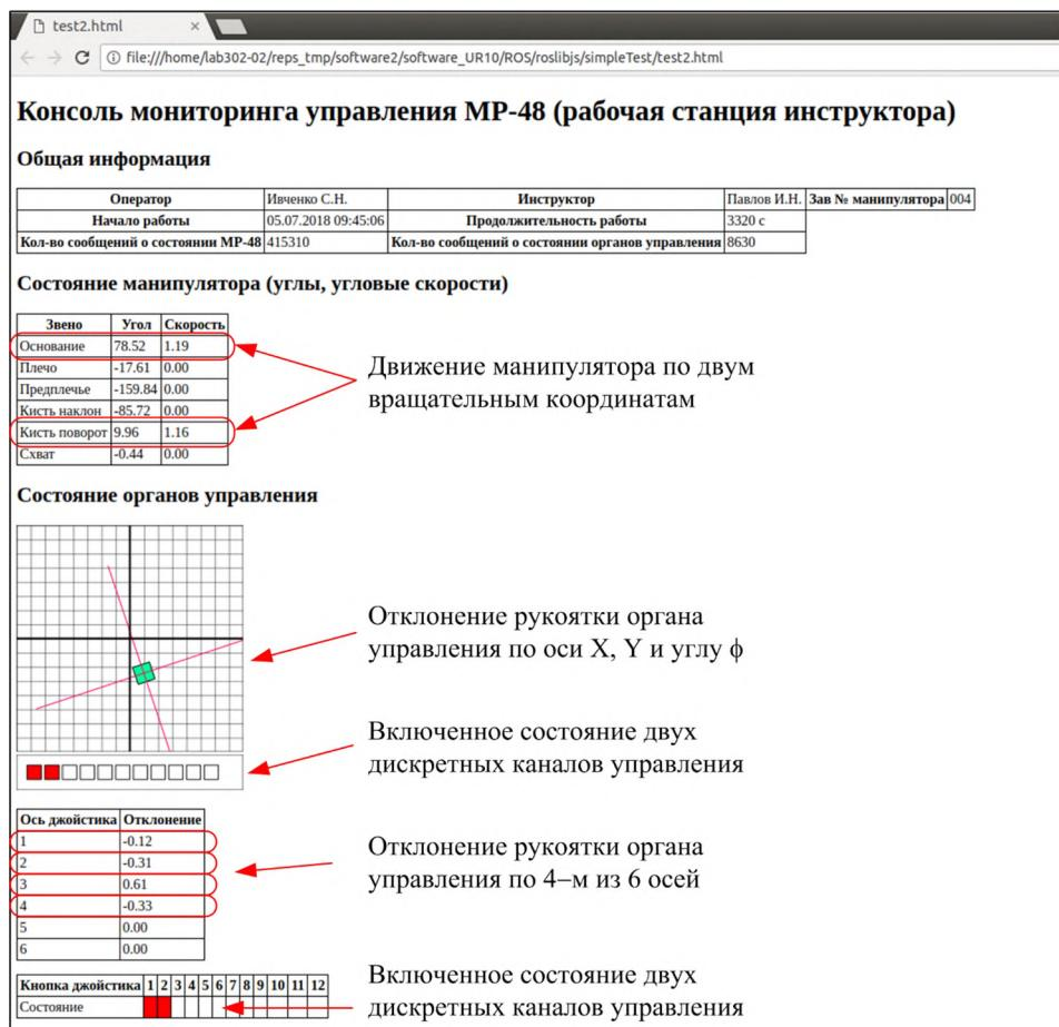
Рис. 16. Пример окна браузера рабочей станции инструктора при воздействии оператора на задающие органы
