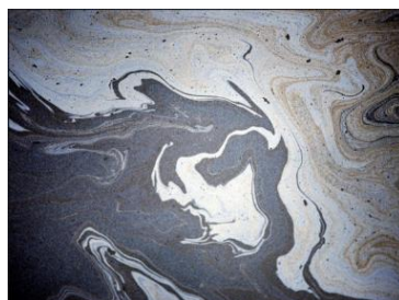
Рис. 6. Грубодисперсное состояние – «масляная пленка на воде»
