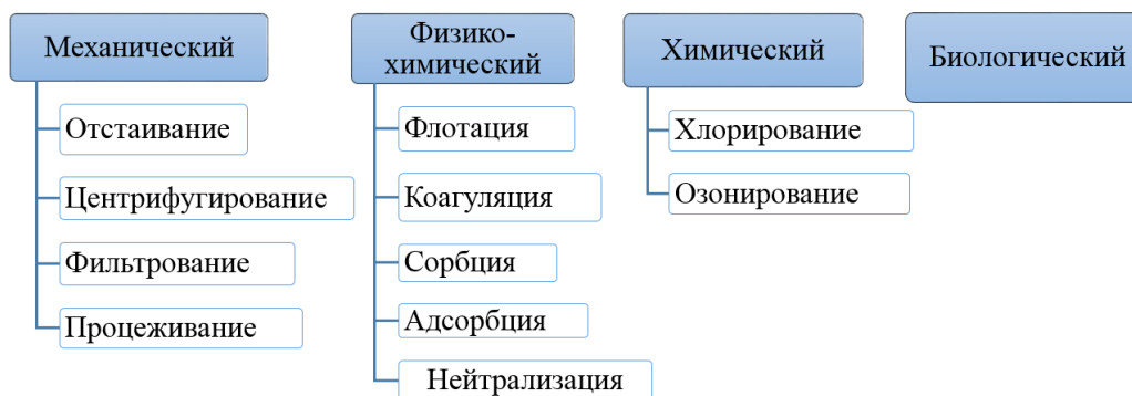
Рис. 1. Методы очистки сточных вод
