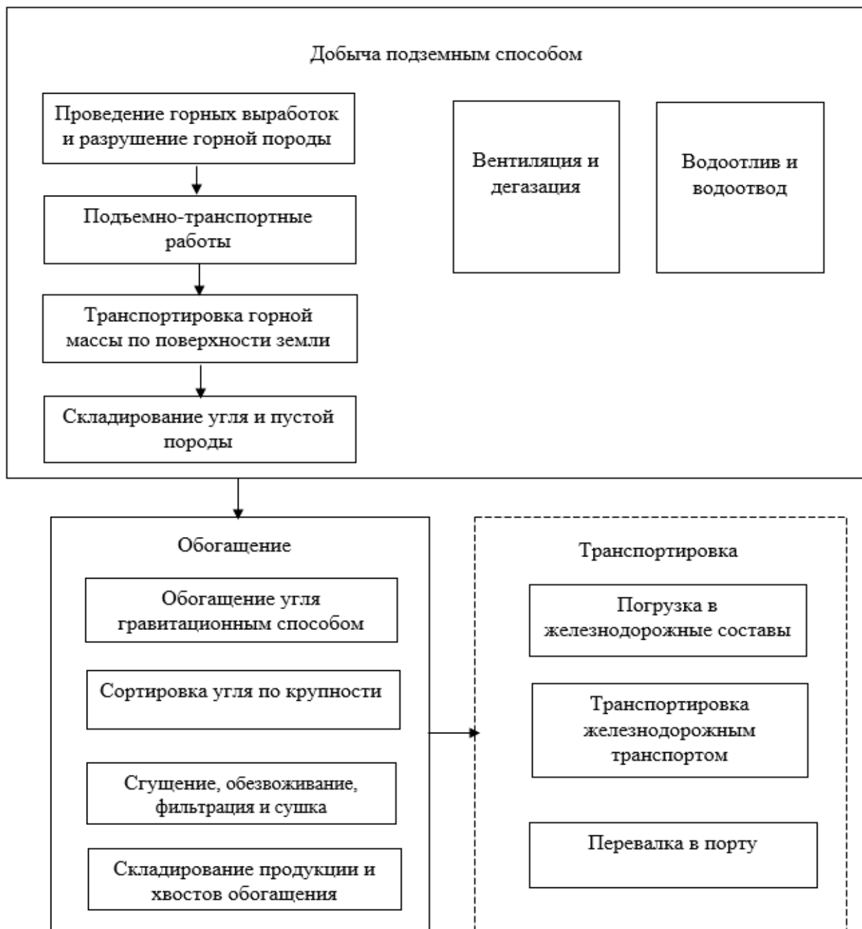
Рисунок 1.7 – Технология процесса добычи угля подземным способом на ПАО «Распадская»
