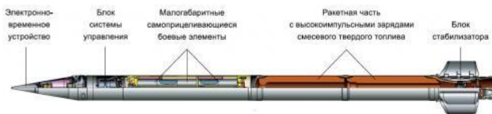
Рис. 3. Реактивный снаряд с кассетной ГЧ с самоприцеливающимися БЭ
