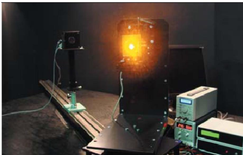
Рис. 1. Внешний вид фотометрической установки «Флакс-7»
