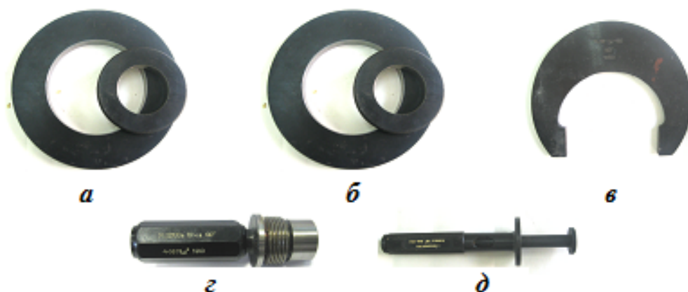
Рис. 6. Специальный контрольно-мерительный инструмент: a, б – проходные калибр-кольца; в – непроходная калибр-скоба; г – резьбовая калибр-пробка; д – глубиномер
