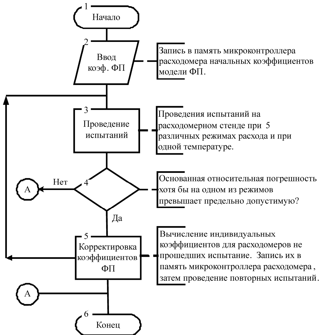
Рис. 2. Схема алгоритма испытаний при серийном производстве расходомеров
