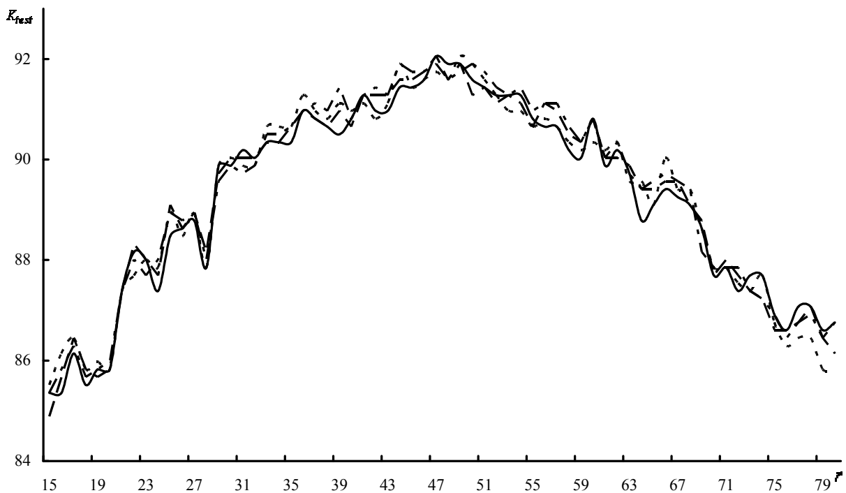
Рис. 3. Зависимость коэффициента распознавания тестового набора от числа дискриминантных компонент: метод Хаусхолдера (сплошная линия), линейная конденсация (CF = 1,5 – пунктирная линия; CF = 2 – штрихпунктирная линия; CF = 2,5 – штриховая линия)
