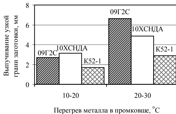
Рис. 3. Влияние перегрева металла в проковше на выпучивание узкой грани слябовой заготовки толщиной 270 мм
