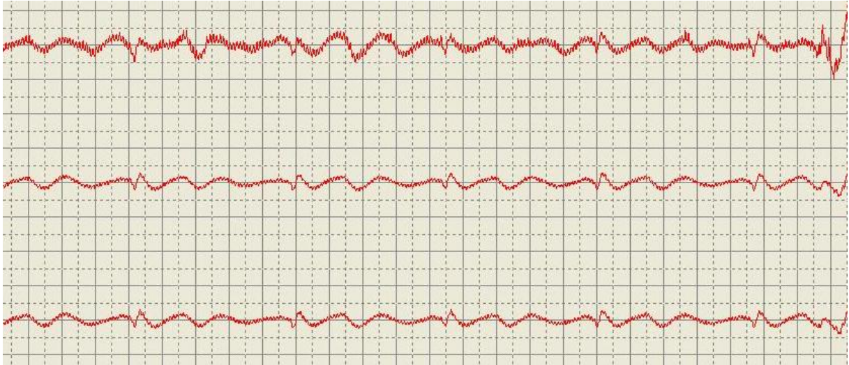
Рис. 6. Электрокардиограмма, снимаемая с руля
